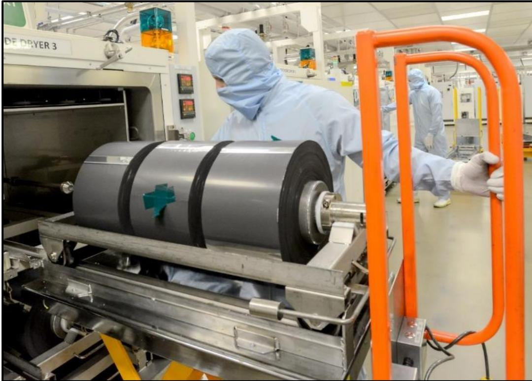
Figure 7. Dépose des bobines dans les séchoirs
